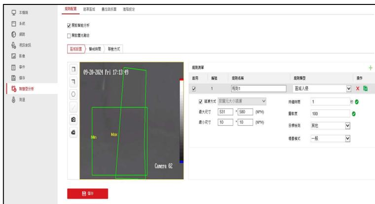
**步驟1.** 「規則配置」，可新增智慧分析規則類型(穿越警戒線/區域入侵/進入區域/離開區域)，設定檢測條件、偵測區域、警戒時間與聯動方式。
