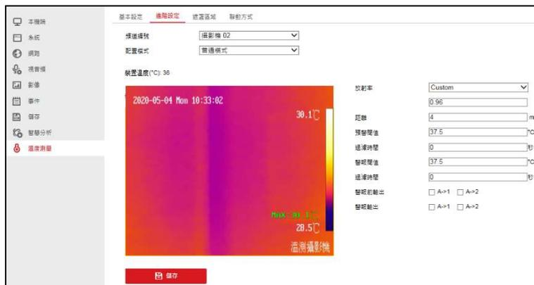
步驟2. 「進階設定」，可設定溫度訊息顯示、紅外線放射率及距離。
