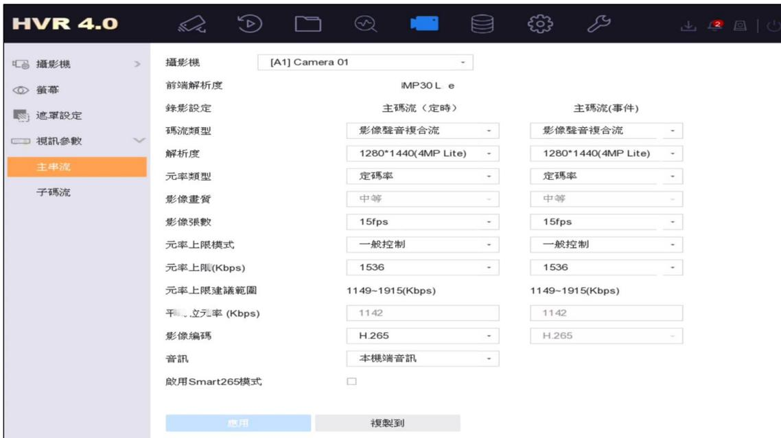
DVR 可以設定在一般狀況下，用較低的錄影畫質來錄影，以節省硬碟空間，但是當一發生事件 (警報、位移偵測、智慧偵測異常) 時，馬上提高錄影畫質來取得重要時刻的清晰畫面。
