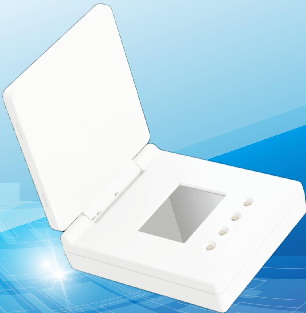
AR-661UG-L為一輕巧便利、簡單操作的手持型 UHF 無線射頻辨識讀取器，符合ISO18000-6C(EPC GEN2)所有標準協訂。內建2.2吋LCD螢幕與25dBm射頻模組與天線，透過簡易的操作行為，直接在LCD螢幕上獲得標籤或是設定的卡號的資料。適合於單一筆資料處理。
